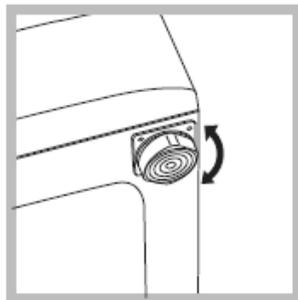
O nivelare precisă conferă stabilitate mașinii și evită vibrații, zgomote sau deplasări pe durata funcționării. În cazul mochetelor sau a unui covor, reglați piciorușele astfel încât să mențineți sub mașina de spălat un spațiu suficient pentru ventilare.
