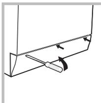
3. scoateți panoul de acoperire din partea din față a mașinii de spălat folosind o șurubelniță (a se vedea *figura*).
