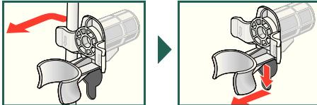
4. Montați capacele și fixați-le ferm prin apăsarea pe cârligul de fixare. Montați suporturile pentru furtun.
