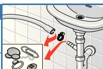
1. Desfaceți colierul furtunului și scoateți cu atenție furtunul de evacuare (atenție: apă reziduală).
